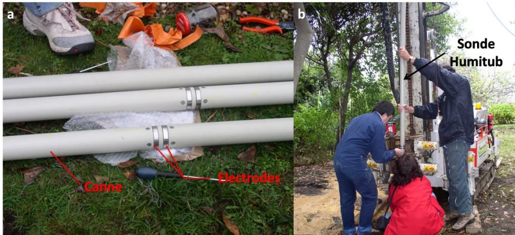
Figure 98 : Détail de la sonde Humitub : électrodes et canne ; b : mise en place de la sonde Humitub
