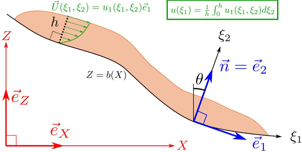
FIGURE 1 : Notations pour les équations d'écoulement en couche mince sur une topographie 1D  $Z = b(X)$ .
