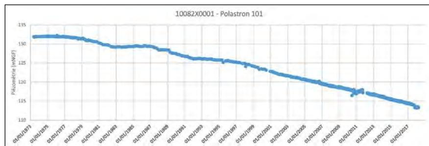
Figure 2. Piézométrie enregistrée au forage de Polastron 101. Source : figure originale pour cet article.
