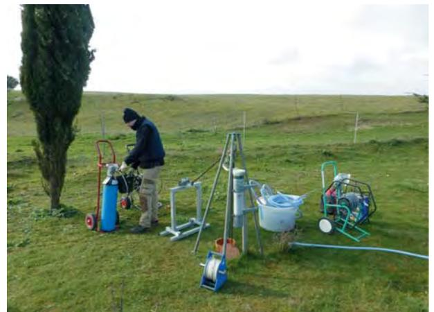
Figure 4. Prélèvements d'eau à différentes profondeurs au forage de Labruguière. Source : Gal et al., 2018b.
