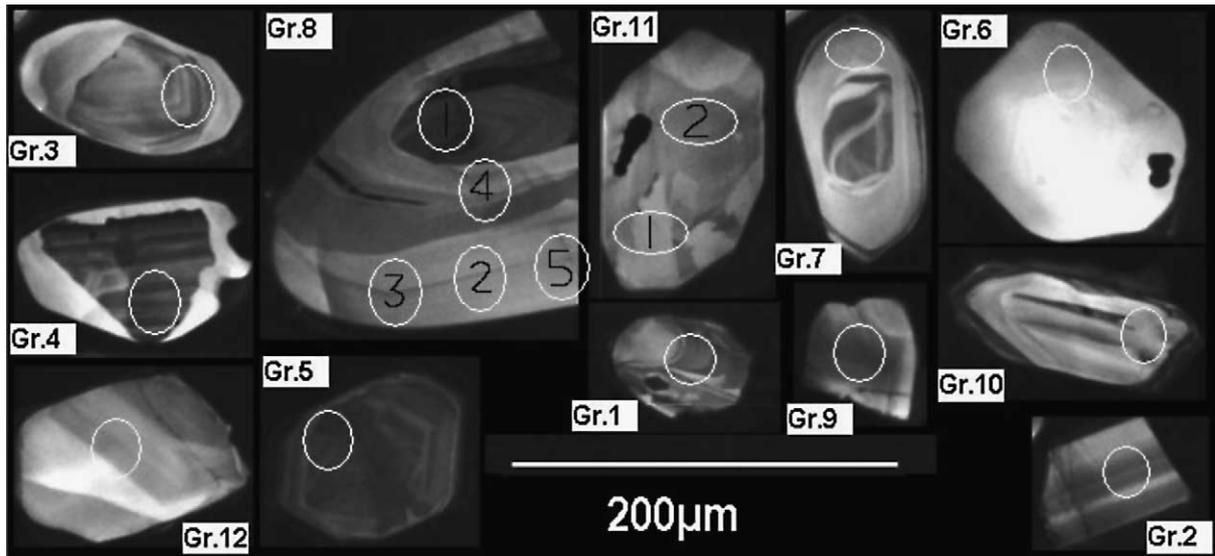
Fig. 2. Image en cathodoluminescence des douze zircons datés par SHRIMP.
