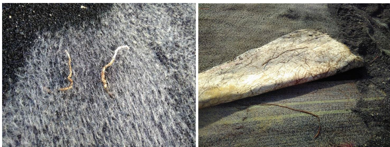
Figure 4. Racine perforant le GSB (gauche) et développement d'un réseau racinaire sur le GSB (droite)
