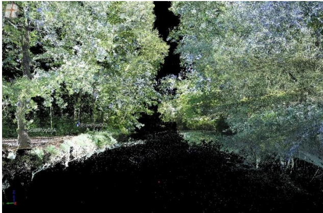
Figure 62 : Aperçu du nuage de points relevé par scanner 3D
