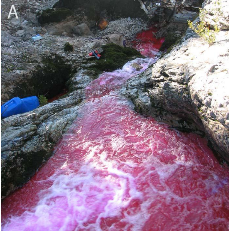
Figure 115 : Injection de sulforhodamine dans la perte située en amont du Mas Martin, le 03/02/2011
