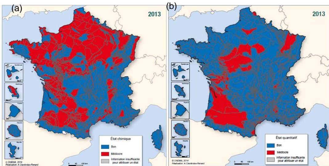
Figure 16. Etat (a) chimique et (b) quantitatif des masses d'eau souterraines (Petit et Michon, 2015)
