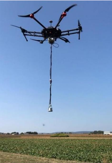
Premiers essais d'un drone équipé d'un magnétomètre en Alsace © E. Pizzo Info Géo Drones
