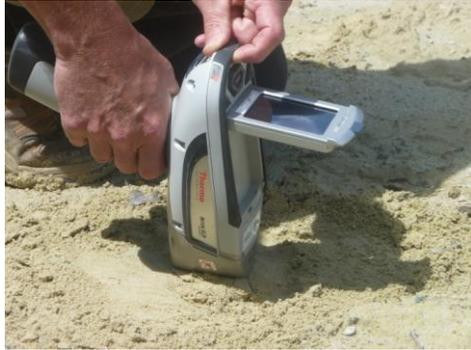
Analyseur portable XRF (X-Ray Fluorescence, non destructif) pour établir la composition chimique
