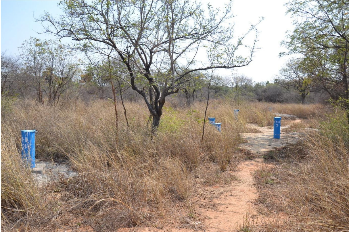
Photo 1 : Dispositif de forages rapprochés sur Choutuppal pour les tests hydrauliques. Source : N. Guihéneuf
