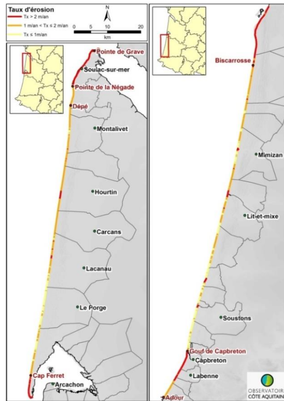
Figure 3. A gauche, taux moyens annuels d'érosion de la côte sableuse aquitaine. A droite, extrait de l'atlas cartographique de l'aléa recul du trait de côte aux horizons 2025 et 2050.
