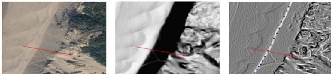
Figure 4. Exemple de détection automatique du trait côte, MNT drapé avec l'orthophoto (à gauche), carte de pente (au centre), carte de courbure longitudinale (à droite).
