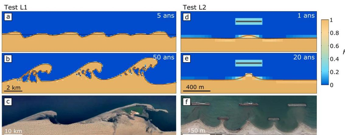
Figure 2. Evolutions simulées pour deux cas académiques (processus *longshore* uniquement et climats de vagues idéalisés). a,b Développement de flèches sableuses. c Côte Namibienne. d,e Effet de l'installation un brise-lame. f Plage de Palavas-les-Flots. Pointillés noirs : trait de côte initial. Adaptée de ROBINET *et al.* (en révision).
