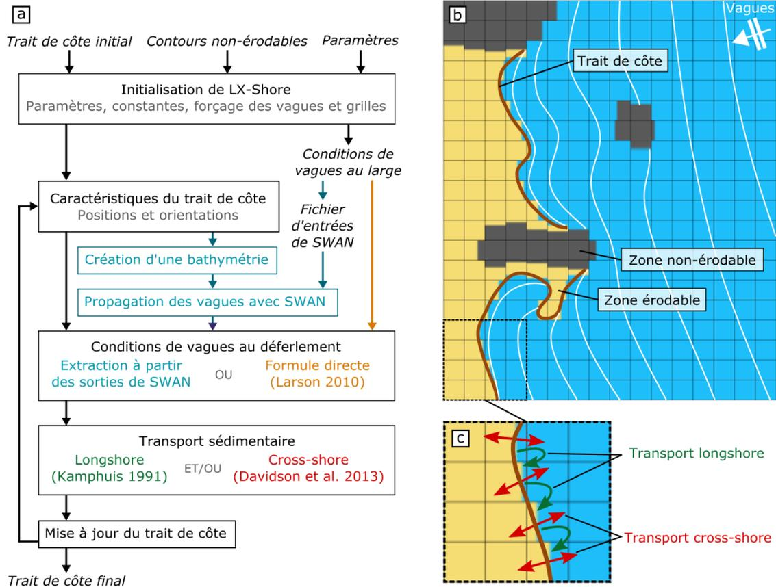
Figure 1. Principales caractéristiques et architecture fonctionnelle de LX-Shore. Adaptée de ROBINET (2017).
