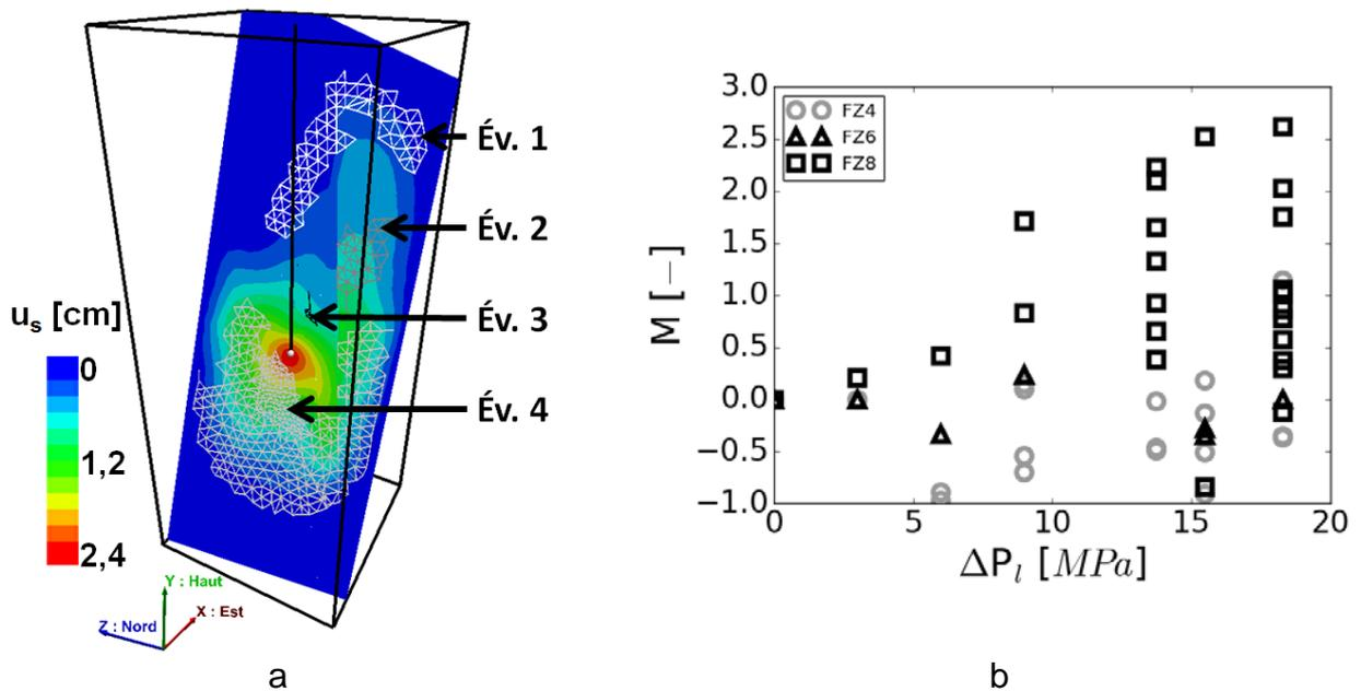
Figure 5. Magnitude des événements microsismiques : a. illustration de l'individualisation des événements sur FZ8 lors du dernier palier de surpression, et b. moments sismiques des événements individualisés sur les FZ4, FZ6 et FZ8
