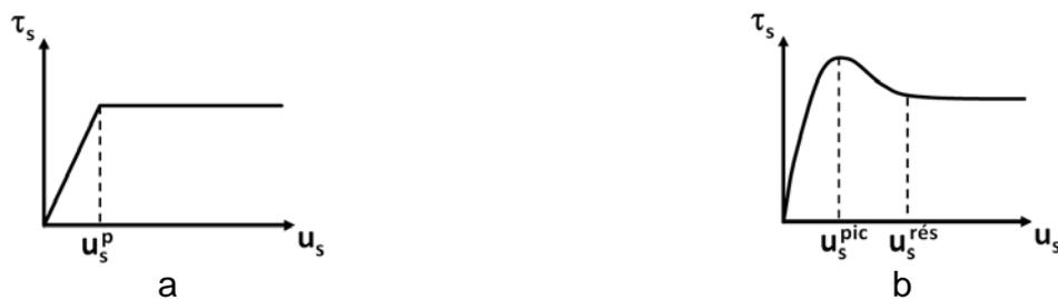
Figure 6. Deux lois de comportement en cisaillement : a. Mohr-Coulomb et b. pic-résiduelle (CYJM de 3DEC<sup>TM</sup>)
