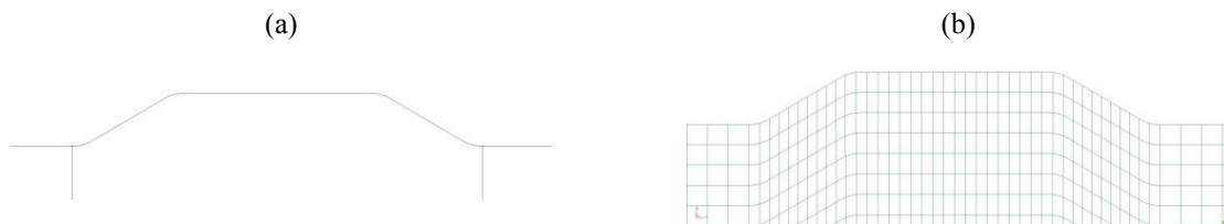
Figure 3. (a) Butte avec angle arrondi. (b) maillage en quadrangles à 9 nœuds permettant une définition quadratique des arêtes des quadrangles.
