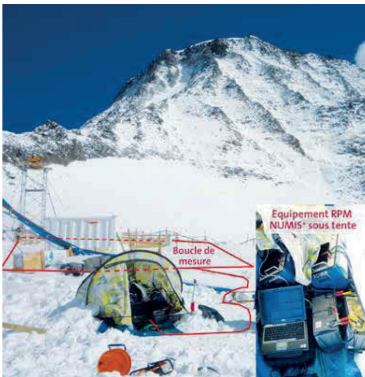
▲ Suivi de la poche d'eau intraglacière de Tête Rousse (altitude 3 200 m) par sondage de résonance magnétique des protons (RMP).
