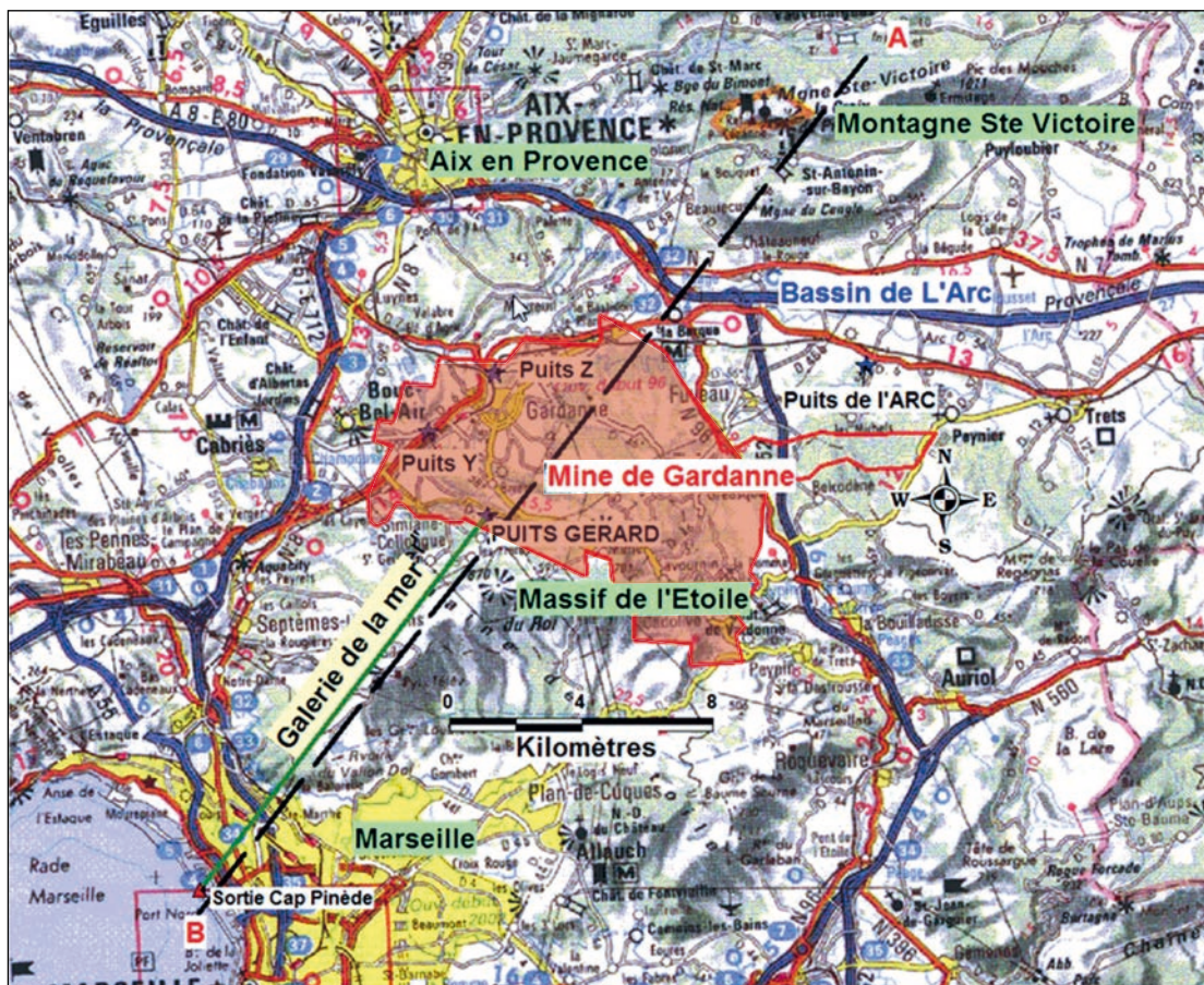
Figure 1 - Localisation de la mine de Gardanne, de ses principaux puits, de la Galerie de la Mer et de la coupe A-B (Figure 3).
