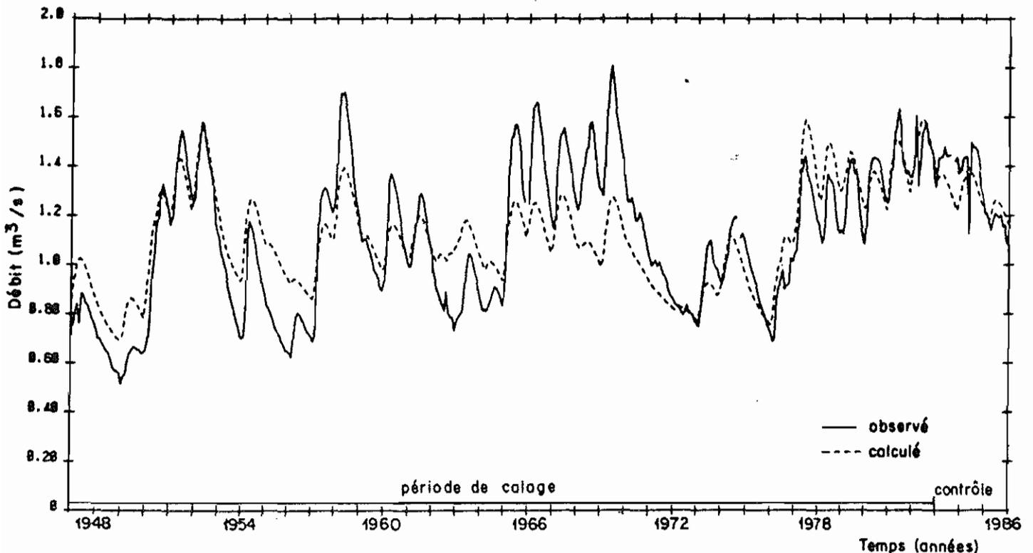
**FIGURE 4 - Sources de Provins : simulation des débits
