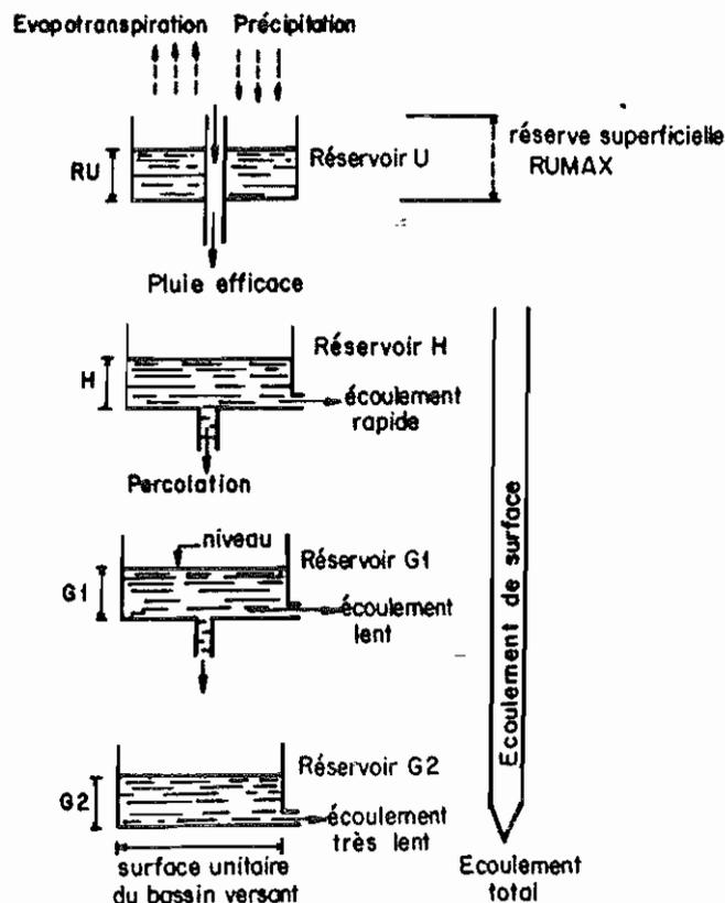
FIGURE 1 - Le modèle hydrologique global GARDENIA (BRGM, 1984)
