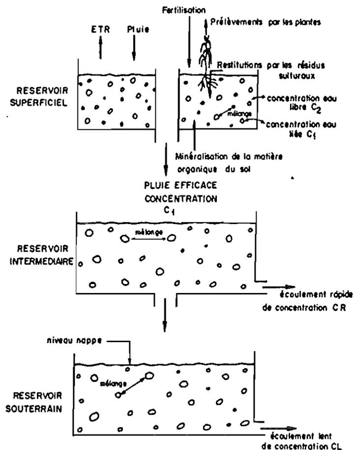
FIGURE 2 - Schéma du modèle BICHE
