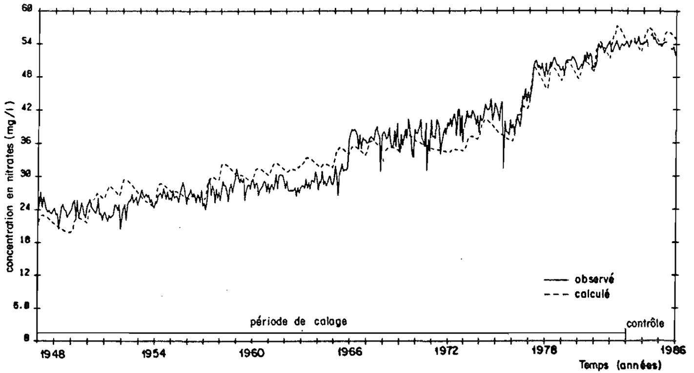
FIGURE 5 - Source de Provins : simulation des teneurs en nitrates
