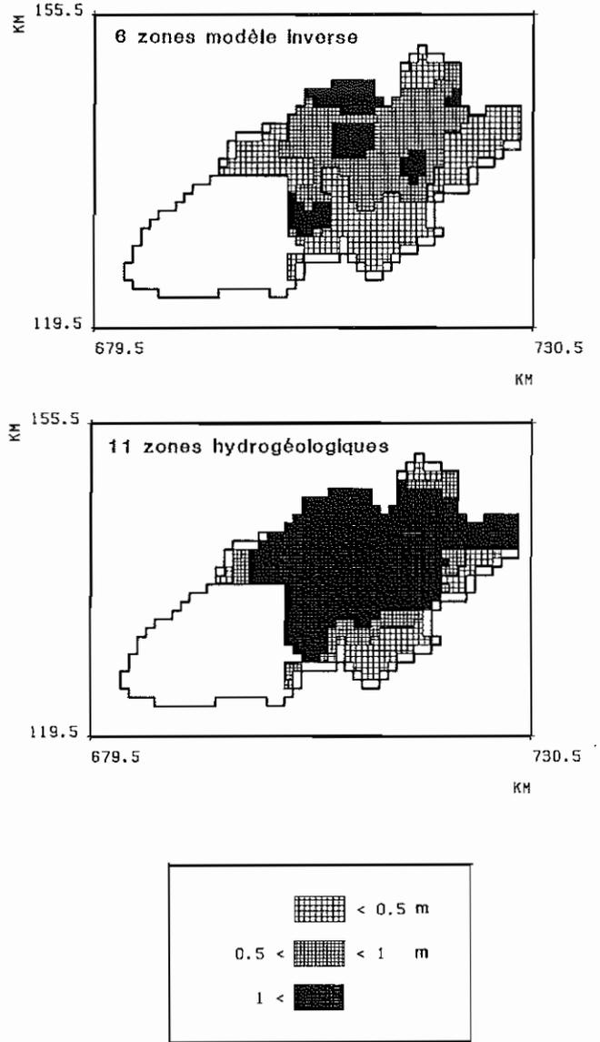
Fig. 9. - Nappe de l'étang de Thau. Ecarts-types de simulation des charges (en m) (the Thau aquifer. Standard deviations of head simulation)
