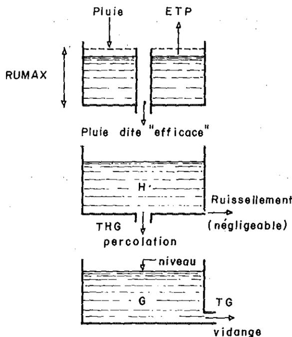
FIG. 1. — Schéma de fonctionnement du modèle de simulation
