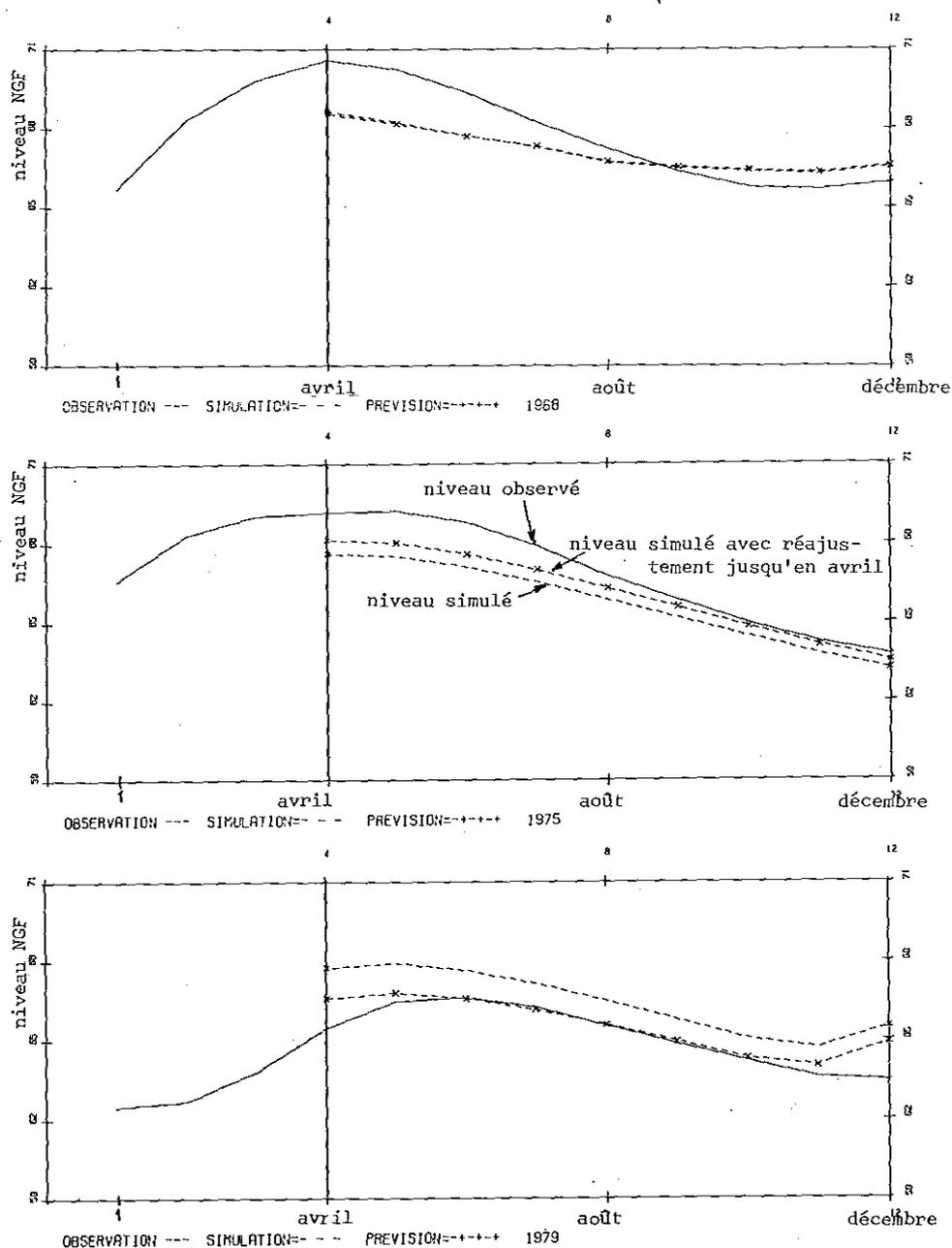
FIG. 6. — Piézomètre Senlis : prévision avec réajustement jusqu'au mois d'avril.
