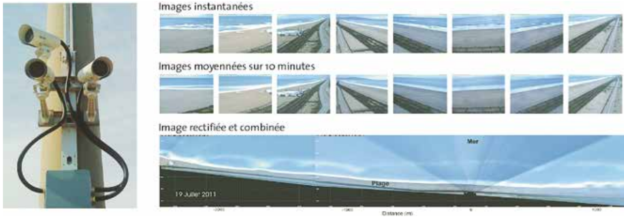
▲ Fig. 1 : Suivi vidéo du Lido de Sète (France) : caméras d'observation (à gauche) et traitement par photogrammétrie des images obliques instantanées et moyennées sur 10 minutes pour obtenir une image en plan de la plage du Lido (à droite).
