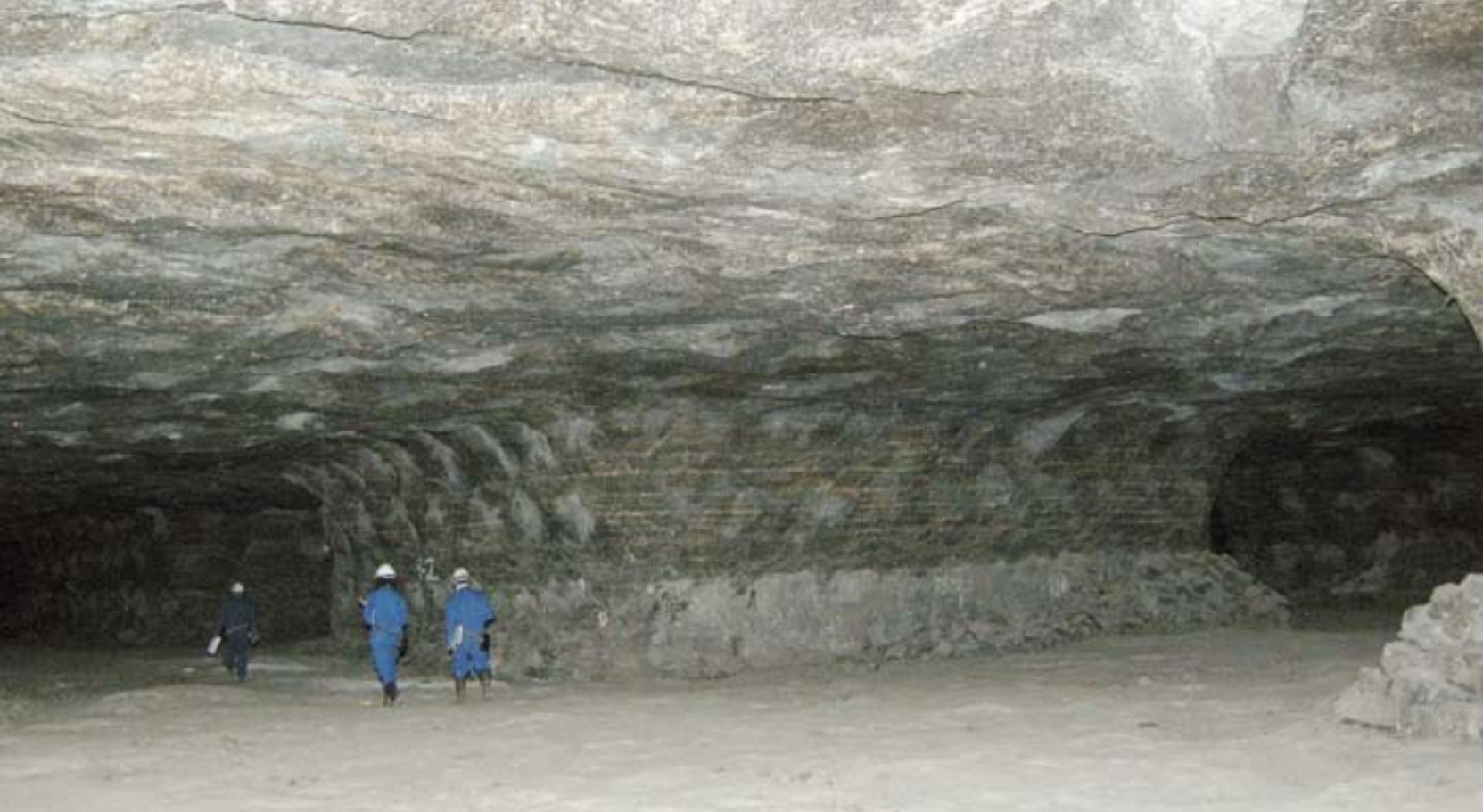
▲ Mine de sel à Einville-au-Jard (Meurthe-et-Moselle) Exploitation selon la méthode des chambres et piliers abandonnés. Room and pillar Einville-au-Jard salt mine (Meurthe-et-Moselle). © SALINS Varangéville/C.Lheur.
