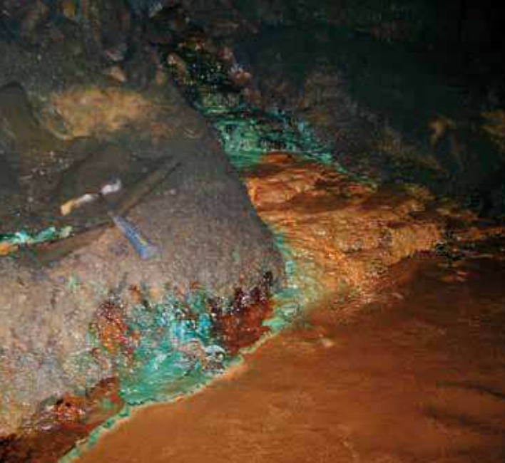
◀ Photo 4 : Écoulement d'eau en paroi d'une galerie de la mine de fluorine du Burg (Tarn) ; la couleur verte est due à l'altération d'une veine de chalcopryrite voisine (sulfure de fer et de cuivre).
