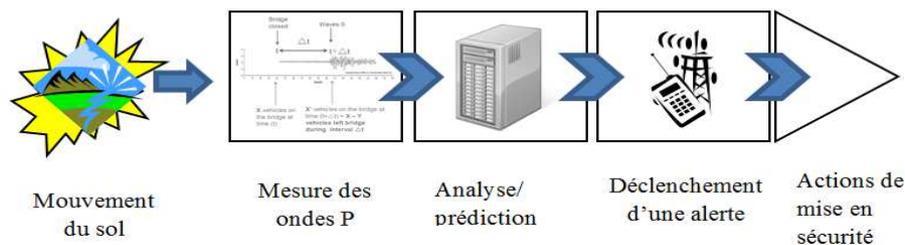
**Figure 1:** Schéma de principe d'un système d'alerte précoce
