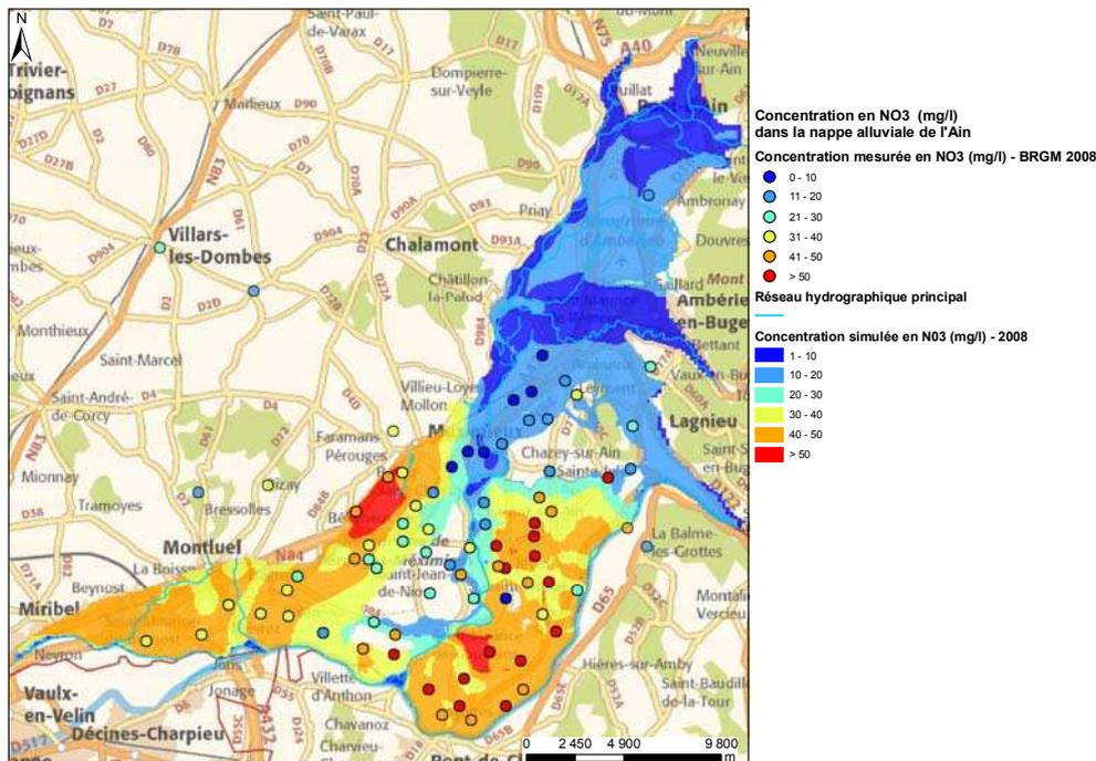
Figure 6 – Résultat de la modélisation: comparaison des concentrations en NO<sub>3</sub> simulées et mesurées en 2008
