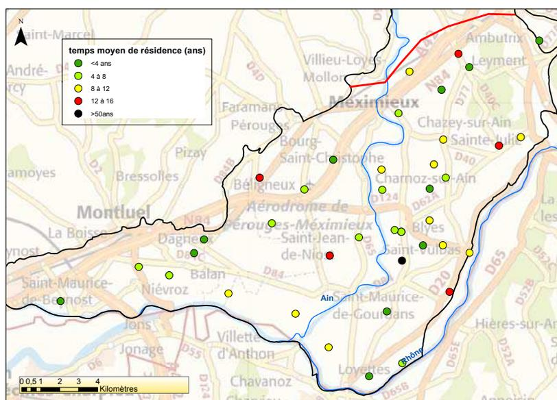
Figure 5 – Carte des temps moyen de résidence estimés à l'aide du modèle exponentiel sur les prélèvements d'eaux souterraines effectués en 2008 et 2009
