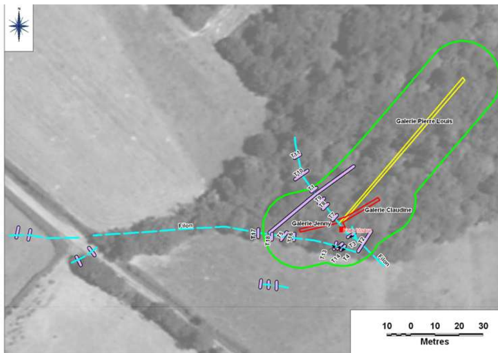
Figure 5 : Plan des travaux miniers du site de La Casine (d'après archives DREAL et fond BD ORTHO ® IGN prise de vue aérienne 2005). Le polygone vert correspond à l'emprise des travaux compte tenu de l'incertitude de localisation de 15 m suite au géoréférencement.
