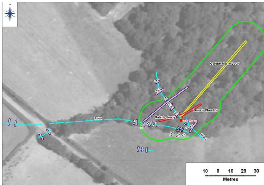
**Figure 5 : Plan des travaux miniers du site de La Casine (d'après archives DREAL et fond BD ORTHO<sup>®</sup> IGN prise de vue aérienne 2005). Le polygone vert correspond à l'emprise des travaux compte tenu de l'incertitude de localisation de 15 m suite au géoréférencement.**
