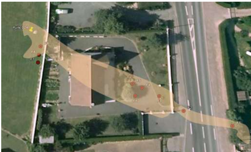
Figure 11 : implantation des forages d'injection en surface
