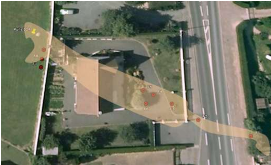
Figure 11 : implantation des forages d'injection en surface
