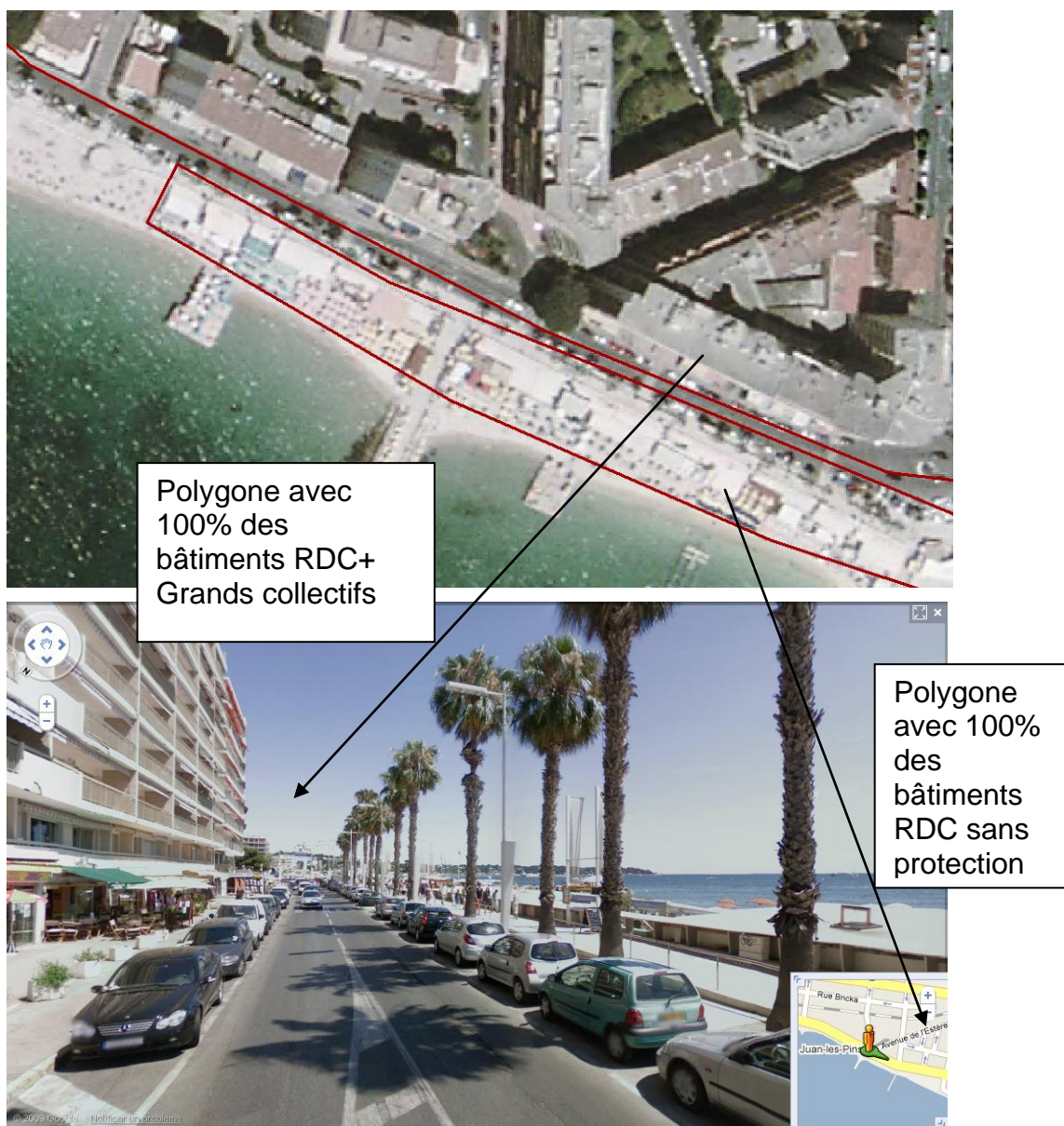
Figure 39 : Exemple de deux polygones de quartiers à Juan les Pins, l'un avec le 100% des bâtiments RDC+ Grand collectif et l'autre avec le 100% des bâtiments en RDC simple sans protection. Sur l'image en bas une vue via Google Street de ces deux polygones.
