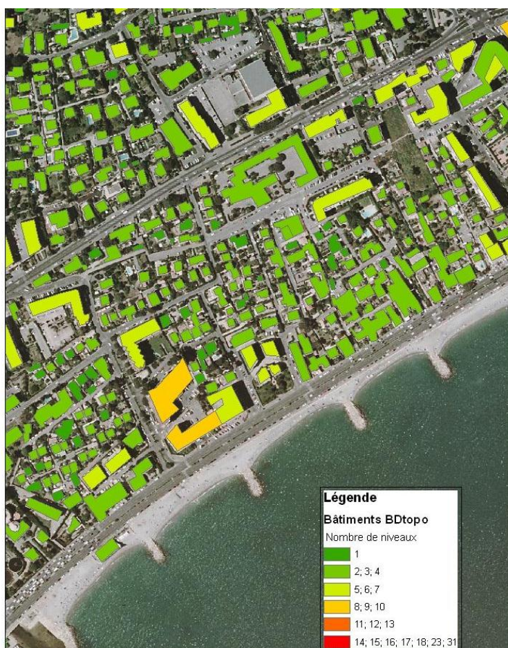
Figure 37 : Estimation du nombre de niveaux des bâtiments sur la base de la BD topo, exemple d'un secteur de Cagnes sur Mer.
