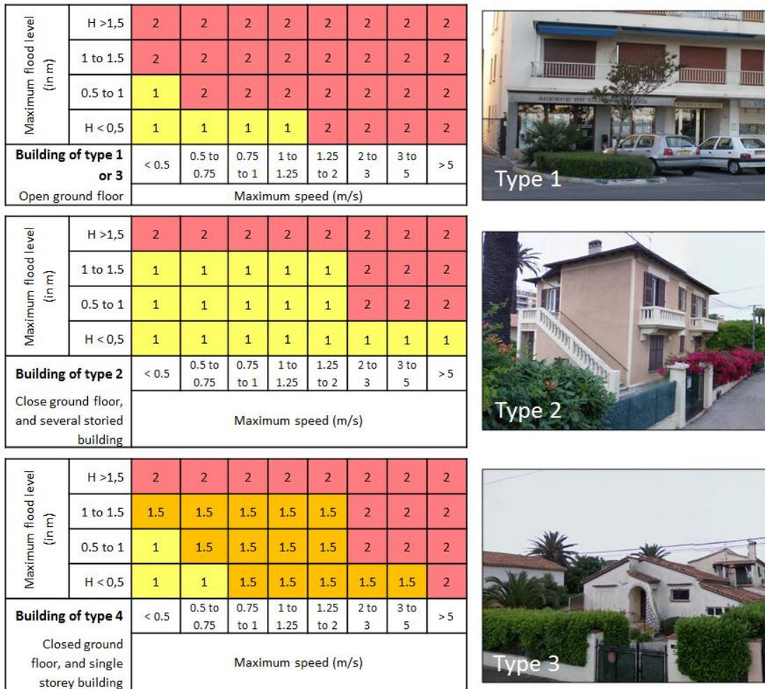
**Figure 5.** Matrices d'exposition aux tsunamis en fonction du type de bâti
