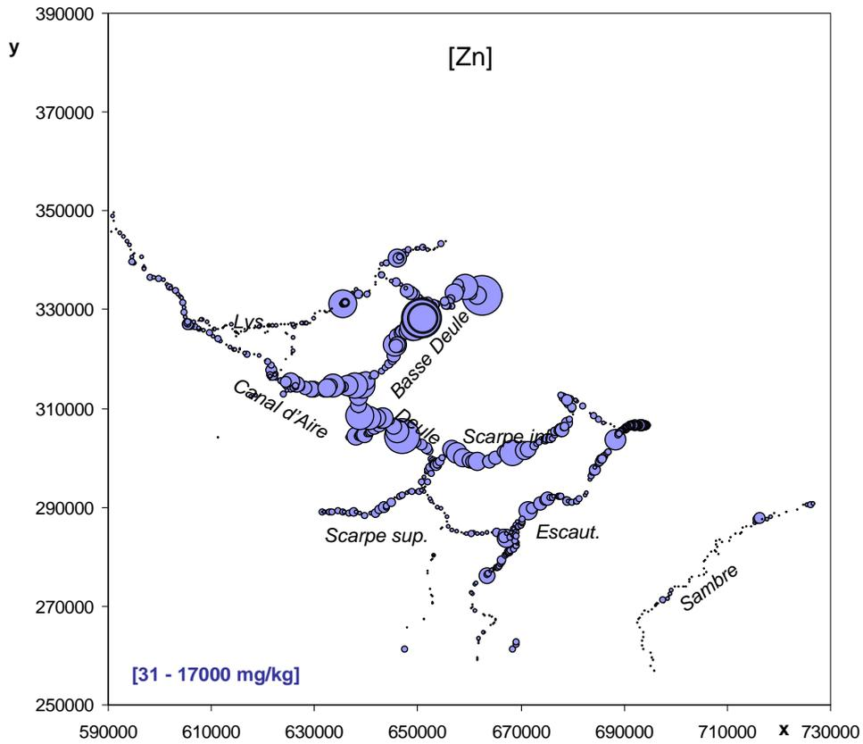
**Figure 4 : Variabilité des concentrations en Zn dans le réseau hydrographique de la région Nord – Pas de Calais, (données VNF; n=858). Le diamètre des cercles est corrélé à l'éventail des concentrations qui s'étale de 31 à 17000 mg/kg.**
