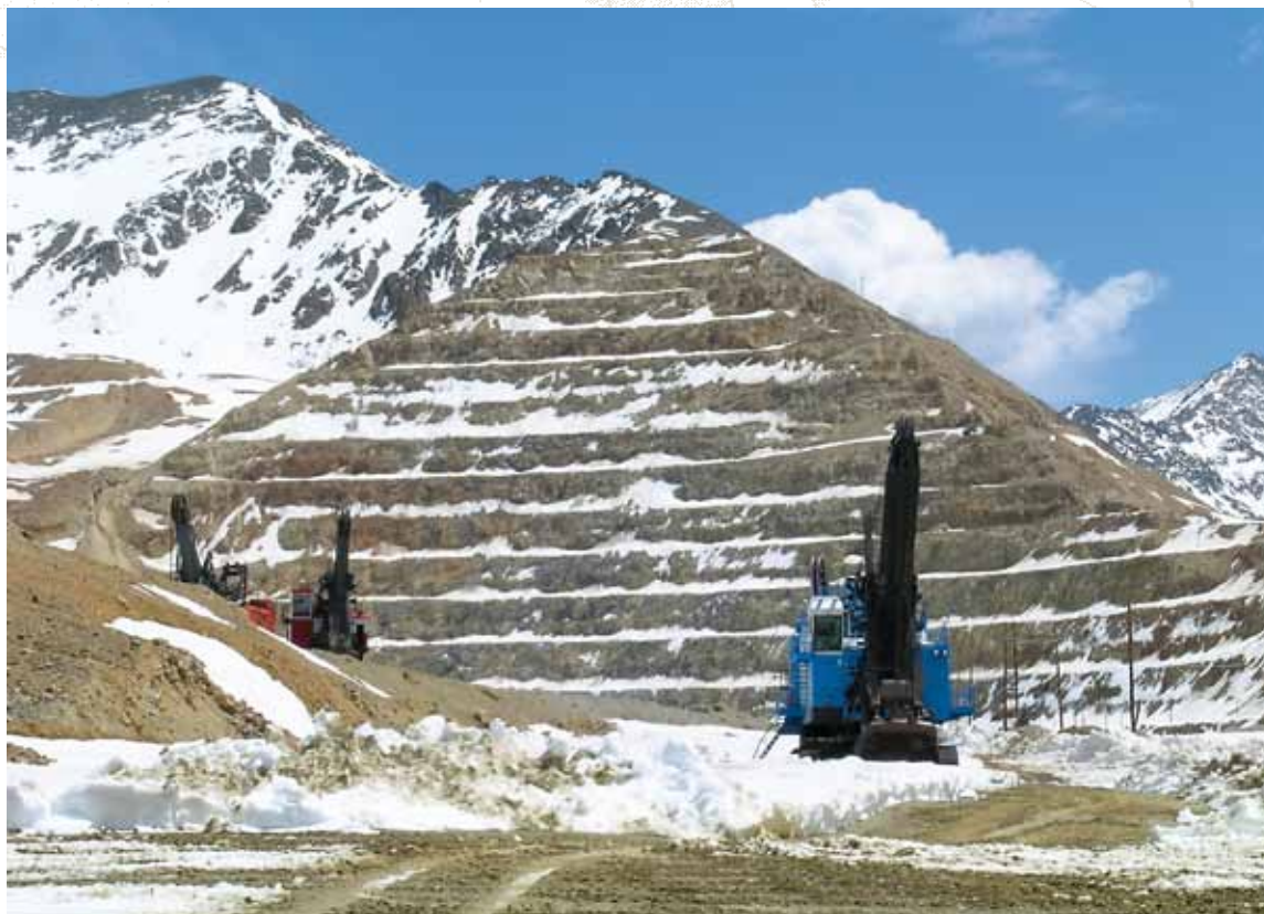
◀ Photo 1 : Mine de molybdène de Climax ( \approx 1\text{Gt} @ 0.4\% Mo) située à près de 3\,500\text{ m} d'altitude au cœur des montagnes Rocheuses (Colorado, États-Unis). À l'aube du XXI e siècle elle avait produit près de 60\% du Mo mondial.
