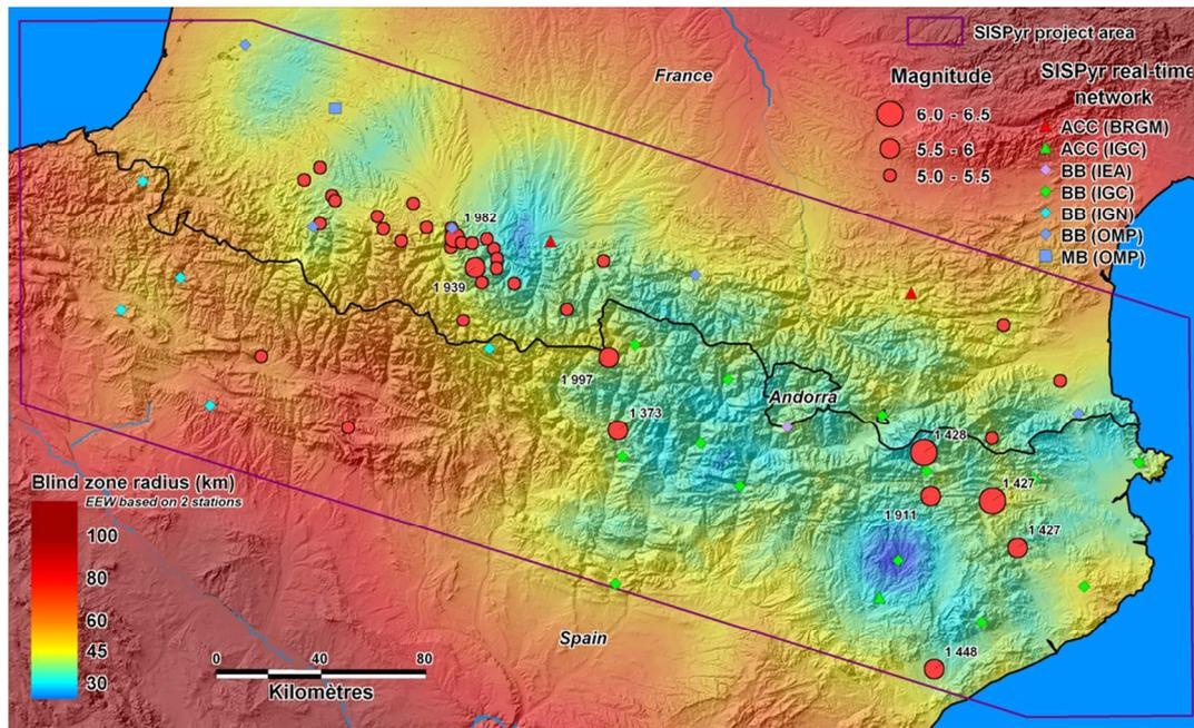
**Figure 2** – Extension de la zone d'ombre en fonction de la localisation de l'épicentre, pour un EEW utilisant le réseau *SISPyrr* temps-réel sur la base de 2 stations au minimum. Sont également représentées les stations temps-réel *SISPyrr* ainsi que les principaux séismes historiques de la région pyrénéenne.
