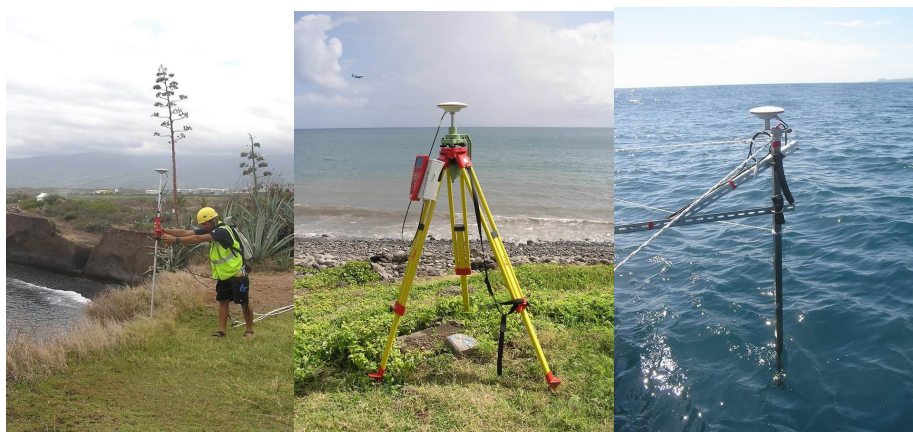
Figure 4. Mesures au DGPS (à gauche et au centre) couplé à un sondeur monofaisceau (à droite) mises en œuvre à La Réunion - photos BRGM 2006
